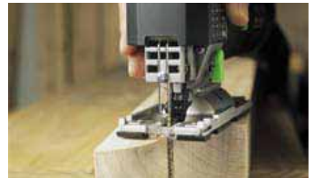
O tirante cursor em esquadria e a tripla guia de serra garantem cortes precisos.
